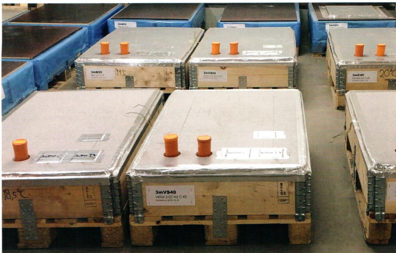
Figur 5. Pågående konceptverifiering inom SBUF 13560 där golvkonstruktioner med olika varianter av modern tät betong i kombination med avjämning och limmad matta testas. Avjämning och limning av matta utförs vid en RF i betongen som överstiger dagens uttorkningskrav.
